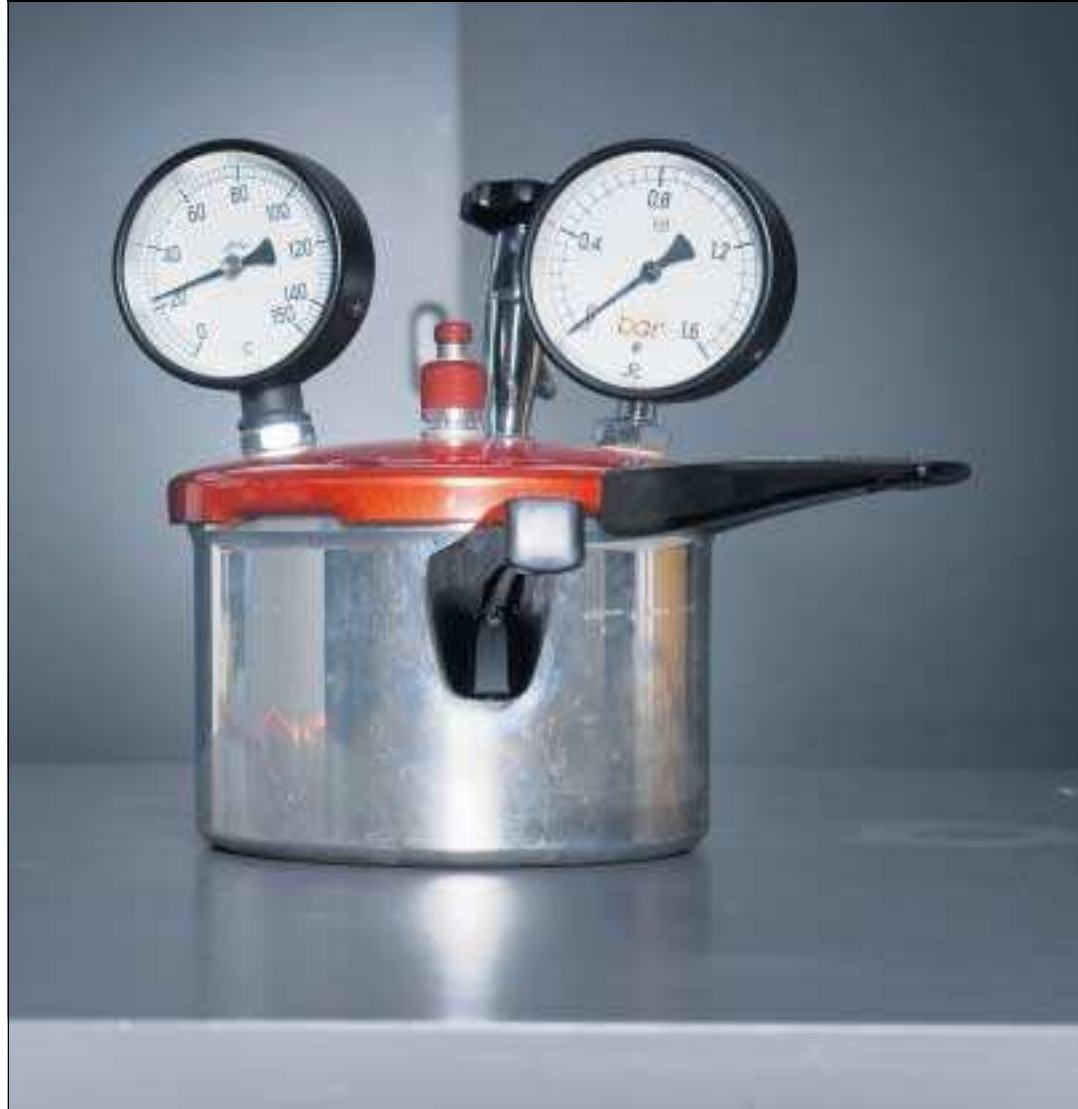
Für den Physikunterricht zeigt der Dampfkochtopf Druck und Temperatur an.
